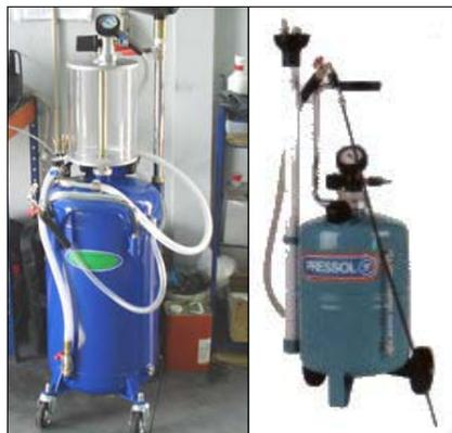
*Máquinas de sucção de óleo para troca a vácuo*
